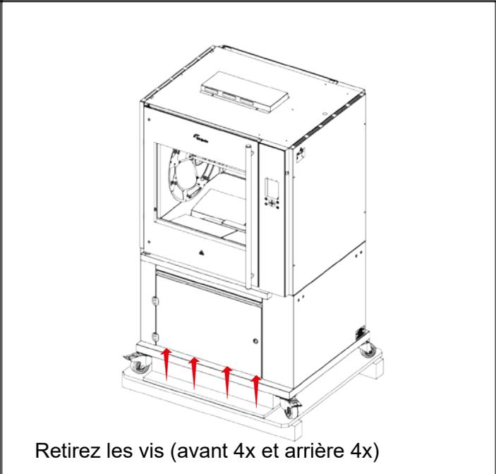
Retirez les vis (avant 4x et arrière 4x)
