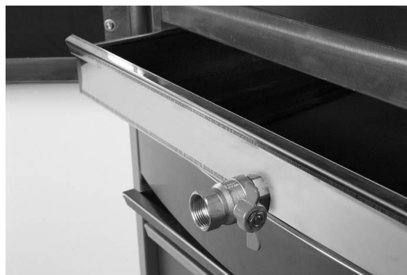
Vanne de purge fermée. (Poignée à la verticale)
