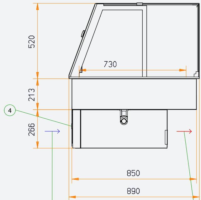
1. Desagüe  $\varnothing 32$  mm | Fuente de alimentación 1~ 230 V 50 Hz (10 A)
