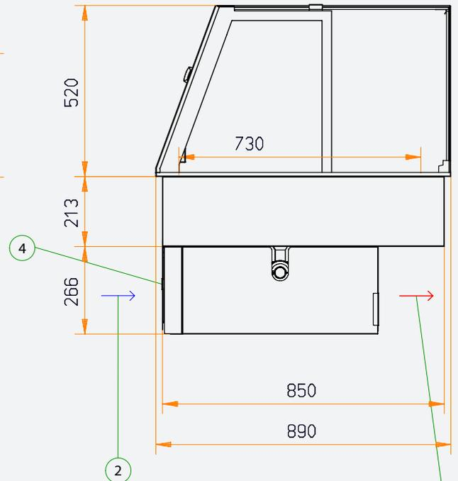
1. Desagüe  $\varnothing 32$  mm | Fuente de alimentación 1~ 230 V 50 Hz (10 A)
