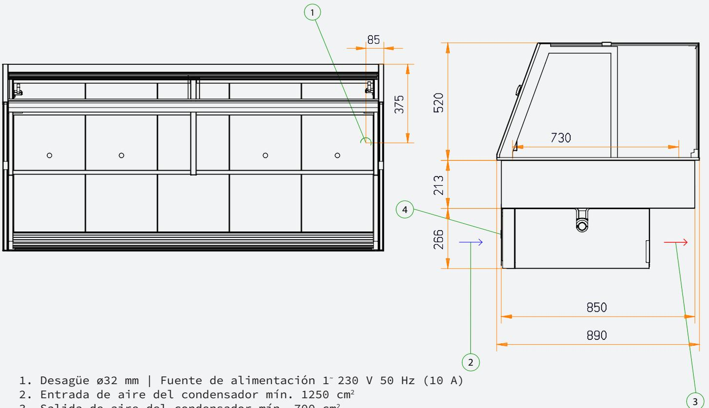
1. Desagüe  $\varnothing 32$  mm | Fuente de alimentación 1~ 230 V 50 Hz (10 A)
